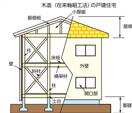
保険の対象となる部分は、住宅品質確保法で定められた構造耐力上主要な部分と雨水の浸入を防止する部分です。
